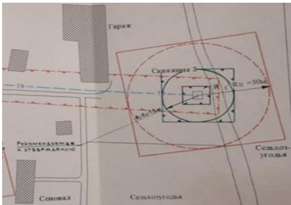
Рисунок 3 – Схема расположения артезианских скважин с. Дутово
